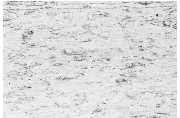
ABBILDUNG 20 | Gefüge mit Karbidausscheidung
